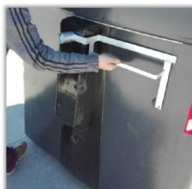
Figura 6. Tag RFID y ubicación en contenedor de carga lateral.
